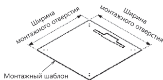
(b) Потолочный монтаж без панели
