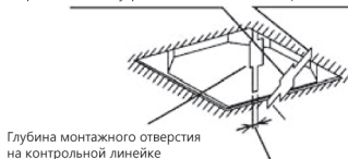
(a) Потолочный монтаж спанелью
